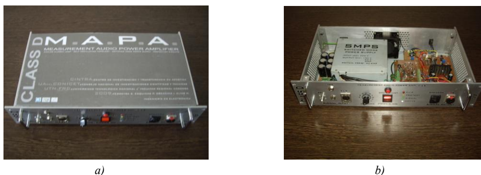
Figura 1. Fotografías del MAPA, gabinete de aluminio y chapa para rack de 19”: a) vista superior exterior, b) vista superior interior
